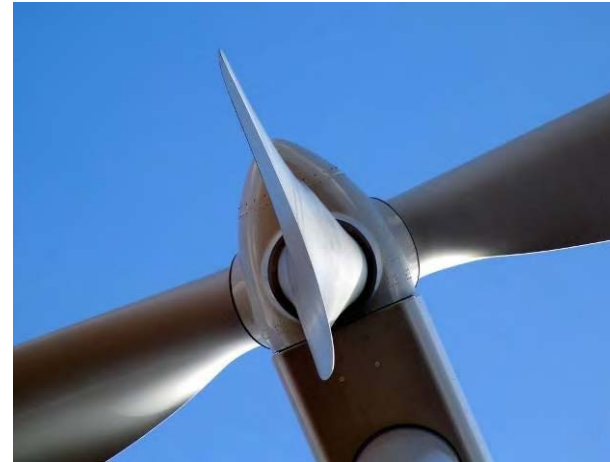
Photo 54 : Annulation de la portance des pales d'éolienne par "mise en drapeau" (Source : Larousse.fr)
