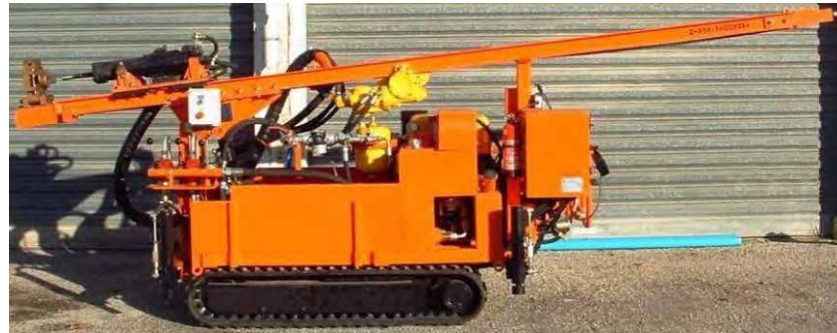
Photo 48 : Sondeuse de type wagon drill hydraulique (Source : FONDASOL)
